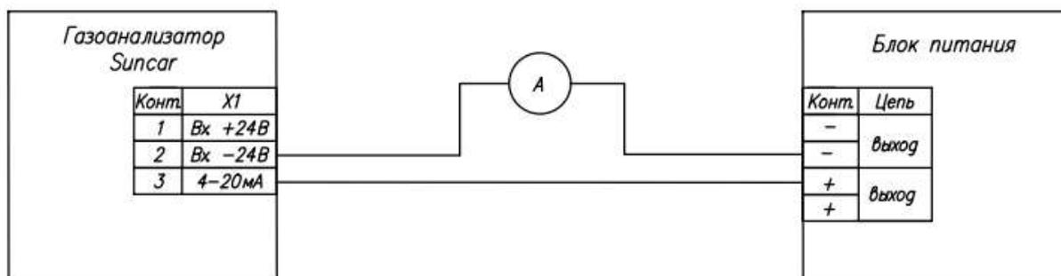
Рисунок 7. Схема подключения по 2-х проводной линии.
