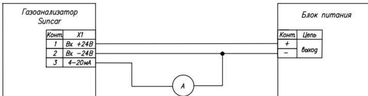
Рисунок 6. Схема подключения по 3-х проводной линии.
