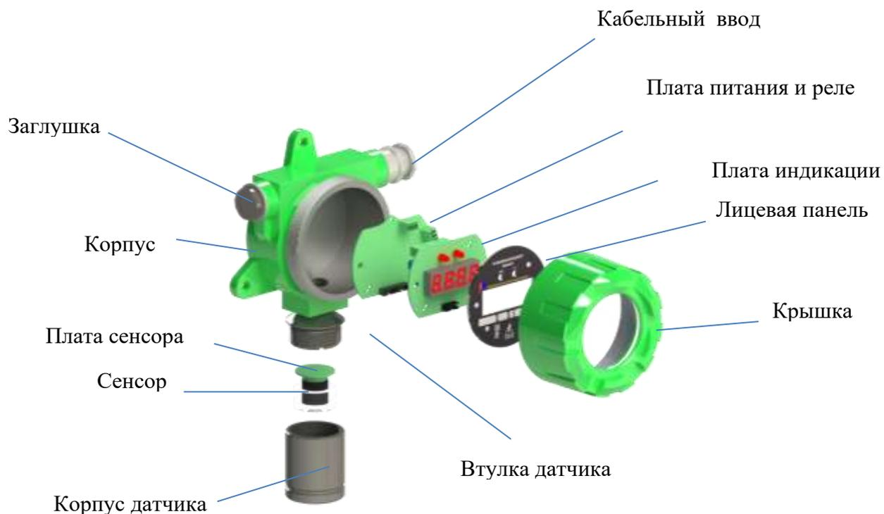
Рисунок 1. Газоанализатор Suncar-XX-XXX-Б-Х
