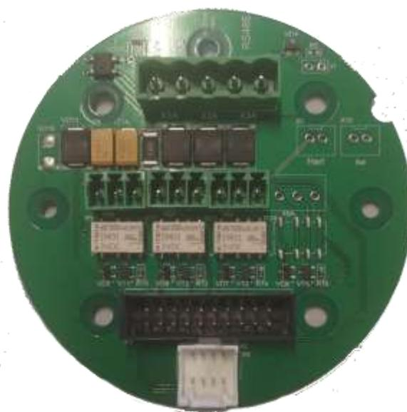
Рисунок 4. Общий вид платы реле
