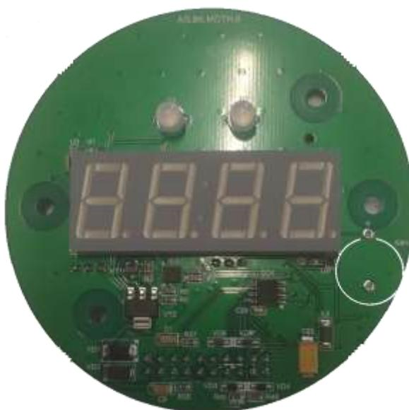
Рисунок 3. Общий вид платы индикации
